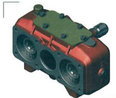
re sino a 60 chilogrammetri di coppia e circa 80 kW di potenza. Due i modelli offerti: con rapporto di 1,26 o 1,59, così da ottenere portate elevate anche da pompe molto piccole. Per entrambi i modelli, il corpo è in ghisa sferoidale, piedini d'appoggio e fissaggio a quattro fori M 14 e assi d'uscita con supporto completo di cuscinetti a rulli conici.
